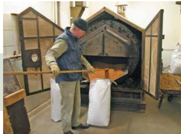
Der Thermo-Ofen in Rosche: das geröstete Getreide wird aus dem Ofen geholt.
